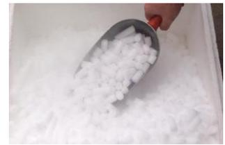
L'état initial est défini par le point  $M$ . La température de la carboglace augmente jusqu'au point  $S$  à  $\theta = -78,5^\circ\text{C}$  où elle change d'état et devient gaz, c'est une sublimation.
